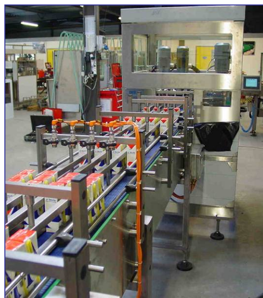
Accumulation en sortie de Répartiteur-Cadenceur.
